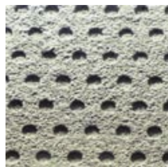
Nopozott szerkezet az optimális vakolattapadáshoz
